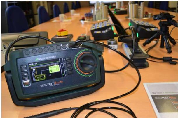
Die neuen Prüfgeräte SECUTEST BASE 10 des Herstellers Gossen Metrawatt sind im Einsatz und vervollständigen die Vorhaltung der GMC-Serie zur Prüfung elektrischer Geräte.
