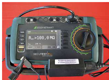
Bild 43: Messung des Isolationswiderstands an einem Netzteil zwischen Primär- und einseitiger Sekundärseite
