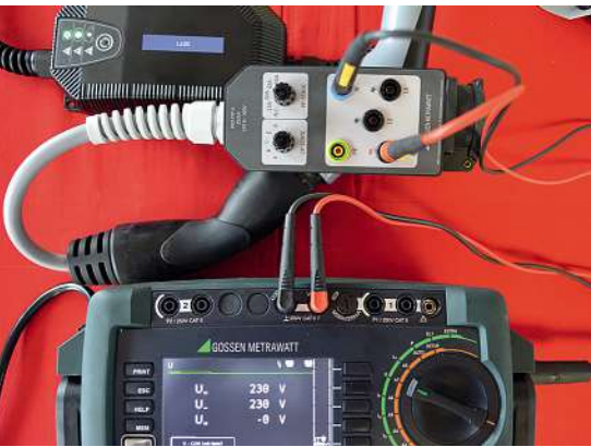
◀ Bild 48: Ladeeinrichtung mit Adapter und Prüfgerät – die Bemessungsspannung entspricht dem zu erwartenden Wert von 230V
