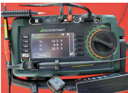
Bild 45: Zweipolige Messung zur Einhaltung der Bemessungsspannung an einem Netzteil
