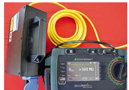
Bild 44: Messung des Isolationswiderstands an einem Schutztrenntransformator zwischen Primär- und einseitiger Sekundärseite
