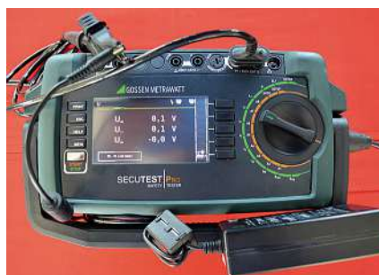
Bild 46: Einpolige Messung zur Einhaltung der Bemessungsspannung an einem Netzteil
