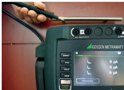
**Bild 36:** Netzverbundmessung für den Berührungstrom am Beispiel einer Geschirrspülmaschine
