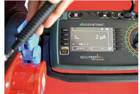
**Bild 40:** Messung des Berührungsstroms als passive Messung mit dem Messverfahren Ersatz-Ableitstrom bei einem Drehstrom-Leitungsroller
