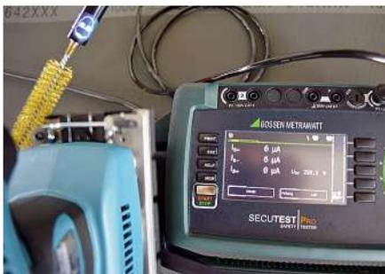
**Bild 35:** Berührungstrommessung an einem Schwingschleifer mit dem Messverfahren der direkten Messung
