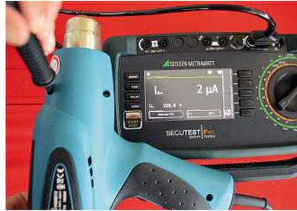
**Bild 39:** Messung des Berührungsstroms als passive Messung mit dem Messverfahren Ersatz-Ableitstrom bei einem Heißluftgebläse
