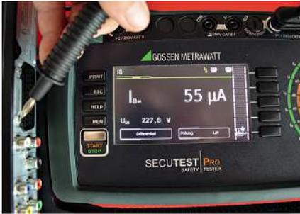
**Bild 38:** Messung des Berührungsstroms als aktive Messung mit dem Messverfahren Differenzstrom bei einem DVD-Spieler
