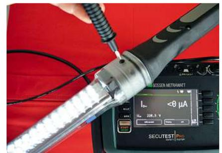
**Bild 37:** Berührungstrommessung an einer Arbeitsleuchte mit dem Messverfahren Differenzstrom
