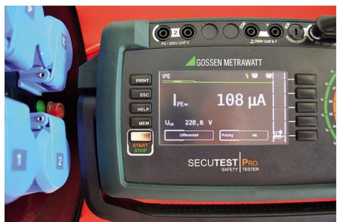
**Bild 33:** Messung des Schutzleiterstroms mit dem Differenzstrommessverfahren bei einem Leitungroller mit einem zu erwartenden Messwert von  $0,108\text{ mA}$
