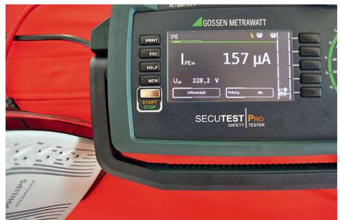
**Bild 30:** Die gleiche Messung als aktive Messung mit umgekehrter Polarität (N/L)
