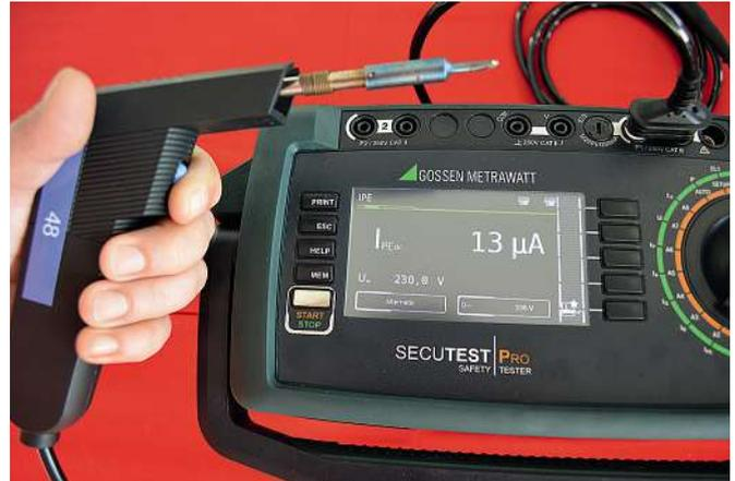
**Bild 31:** Messung des Schutzleiterstroms mit dem Ersatz-Ableitstrommessverfahren bei einem Lötcolben mit einem zu erwartenden Messwert von  $0,013\text{ mA}$
