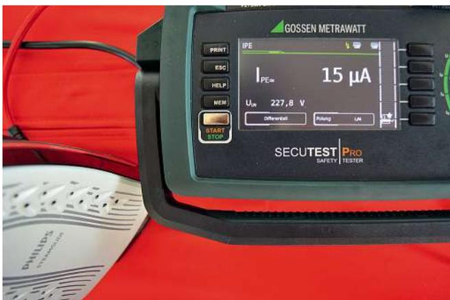
**Bild 29:** Messung des Schutzleiterstroms als aktive Messung (L/N) an einem Bügeleisen
