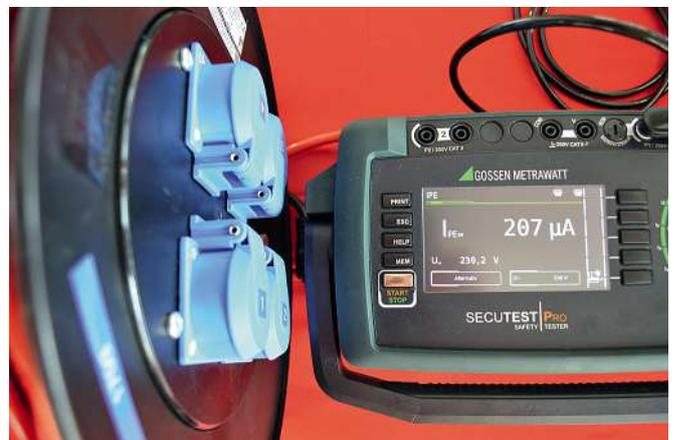
**Bild 32:** Messung des Schutzleiterstroms mit dem Ersatz-Ableitstrommessverfahren bei einem Leitungroller mit einem zu erwartenden Messwert von  $0,207\text{ mA}$
