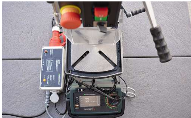
Bild 25: Messaufbau für eine Ständerbohrmaschine – das Messobjekt wurde auf dem Boden festgeschraubt
