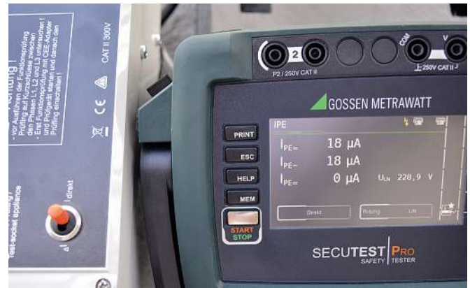
Bild 28: Messung des Schutzleiterstroms als aktive Messung mit dem Messverfahren Direktmessung bei einer Ständerbohrmaschine
