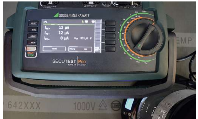
Bild 26: Messung des Schutzleiterstroms als aktive Messung mit dem Messverfahren Direktmessung bei einer Kaffeemaschine
