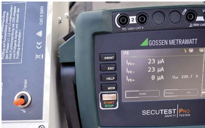
Bild 27: Messung des Schutzleiterstroms als aktive Messung mit dem Messverfahren »Differenzstrom« bei einer Ständerbohrmaschine – hier mit einem zu erwartenden Messwert von 0,023 mA
