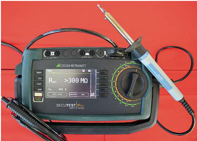
Bild 23a: Messung des Isolationswiderstands über die Prüfdose des Prüfgerätes (L und N gegen PE) und somit zwischen dem Heizstab mit Schutzleiteranschluss gegen die aktiven Teile des LötKolbens
