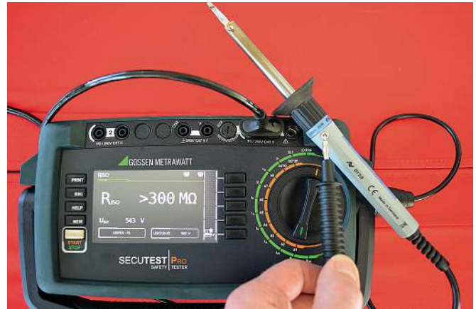
Bild 23b: Messung des Isolationswiderstands über die Prüfdose (L und N) gegen die Sonde des Prüfgerätes und somit zwischen der Befestigungsschraube ohne Schutzleiteranschluss gegen die aktiven Teile des LötKolbens
