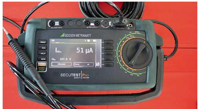
**Bild 20:** Schutzleiterstrom der Anschlussleitung 10m nach dem Messverfahren Differenzstrom ergibt einen Schutzleiterstrom von 51 µA
