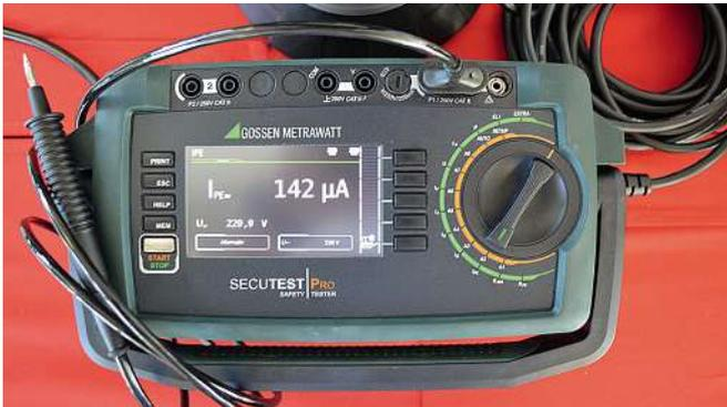
**Bild 17:** Schutzleiterstrom der Tauchpumpe einschließlich Anschlussleitung mit 10m nach dem Messverfahren Ersatzableitstrom ergibt einen Schutzleiterstrom von 142 µA
