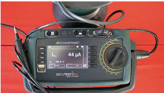
**Bild 19:** Schutzleiterstrom der Tauchpumpe ohne Anschlussleitung 10m nach dem Messverfahren Ersatzableitstrom ergibt einen Schutzleiterstrom von 44 µA
