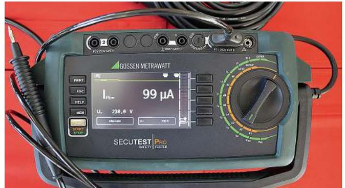
**Bild 18:** Schutzleiterstrom der Anschlussleitung mit 10m nach dem Messverfahren Ersatzableitstrom ergibt einen Schutzleiterstrom von 99 µA
