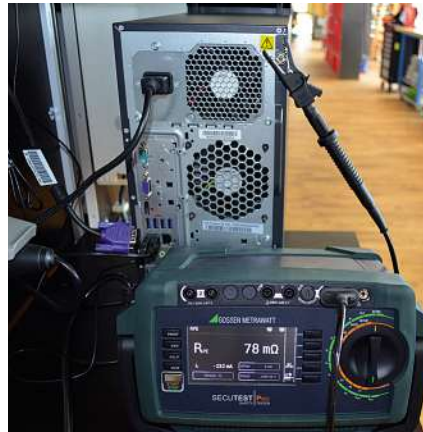
Bild 13: Netzverbundmessung an einer EDV ohne angeschlossene Datenleitung und...
