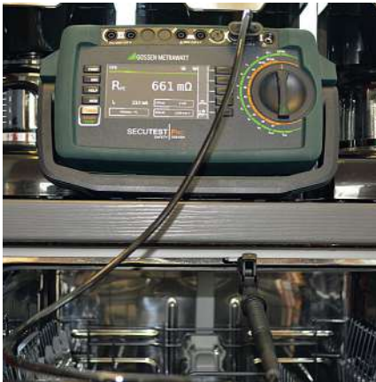
Bild 12: Netzverbundmessung an einer Geschirrspülmaschine
