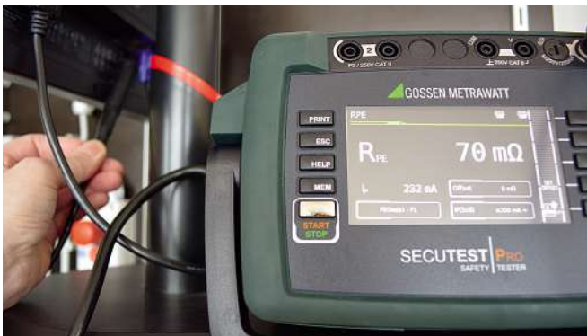
Bild 15: Schutzleitermessung im Netzverbund an einem Monitor mit Anschluss einer Datenleitung und...
