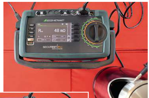
Bild 10: Schutzleitermessung an einem Wasserkocher und ...
