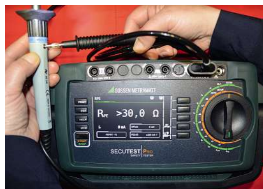
Bild 7: ... während er an dieser Stelle des Lötkolbens nicht angeschlossen ist
