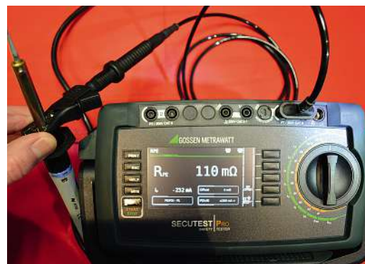
Bild 6: Das gleiche Verfahren mit einem Lötkolben – hier ist der Schutzleiter angeschlossen...
