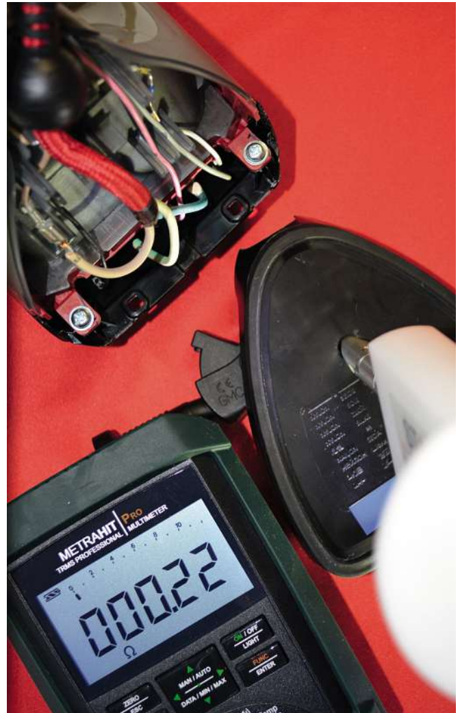
Bild 3: Prüfaufbau zur Messung auf Berührbarkeit
