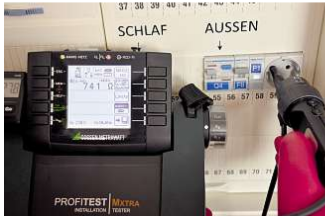
Bild 77: Messergebnis des Erdungswiderstandes bei Verwendung der Position »15 mA« mit 741Ω
