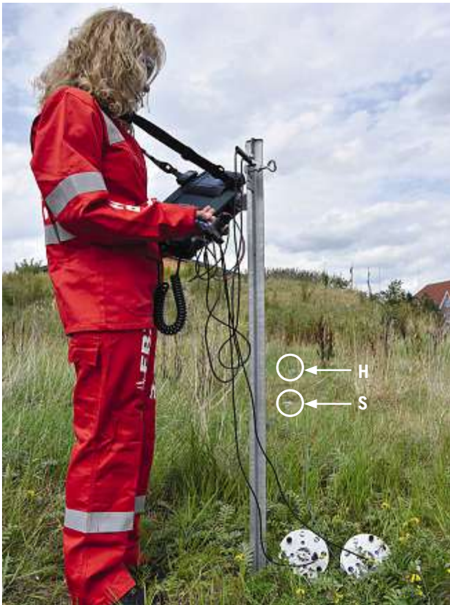
Bild 73: Linearer Aufbau für die 4-Leiter-Messmethode mit Sonde (S) und Hilfserde (H)
