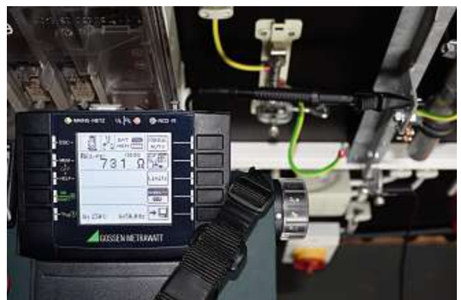
Bild 76: Messergebnis des Erdungswiderstandes mit einem zu erwartenden Wert von 731Ω
