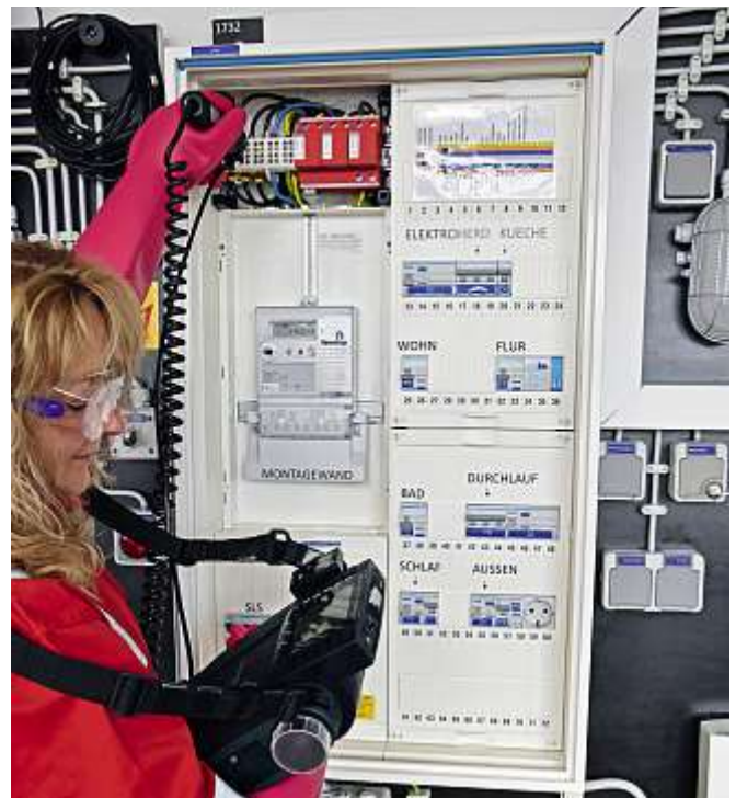
Bild 75: Messaufbau für die Erdfehlerschleifenimpedanz-Messmethode
