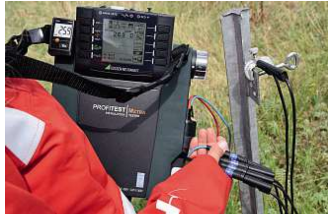
Bild 74: Messergebnis des Erdungswiderstandes mit einem zu erwartenden Wert von 263Ω
