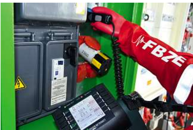
Bild 71: Messung zur Höhe des möglichen Kurzschlussstromes mit 221 A
