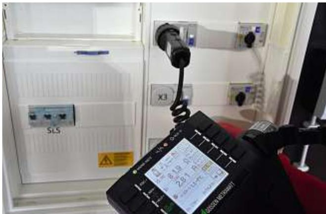
**Bild 66:** Ermittlung des möglichen Kurzschlussstromes ausgangsseitig am LSS mit 2,81 A
