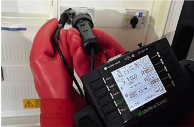
**Bild 64:** Meldung seitens des Prüfgerätes, dass der Wert >10Ω beträgt
