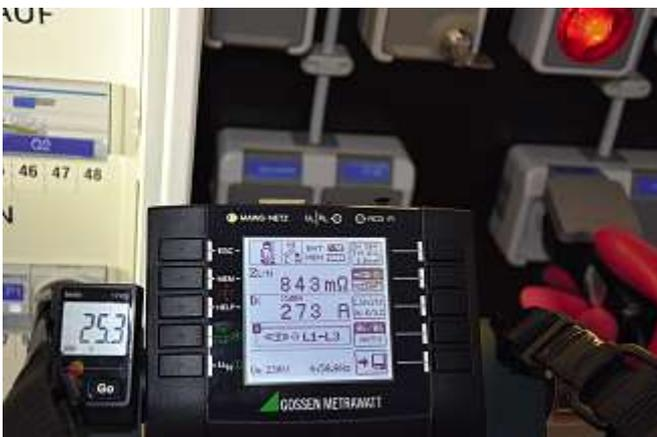
**Bild 62:** Messung zur Höhe des möglichen Kurzschlussstromes mit einem ausreichenden Messwert für  $I_k$  von 273 A
