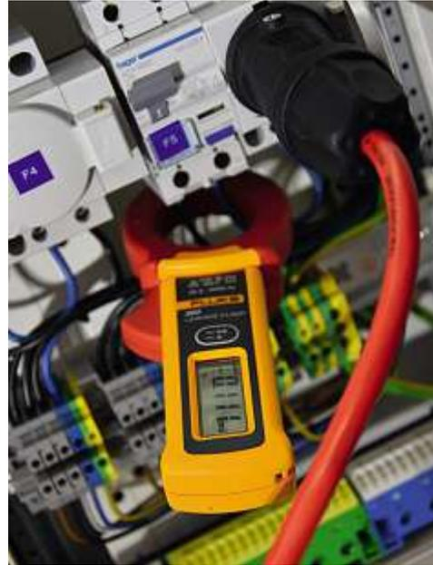
**Bild 61:** Ableitstrom bei Simulation eines Leitungsnetzes mit 0,111 mA
