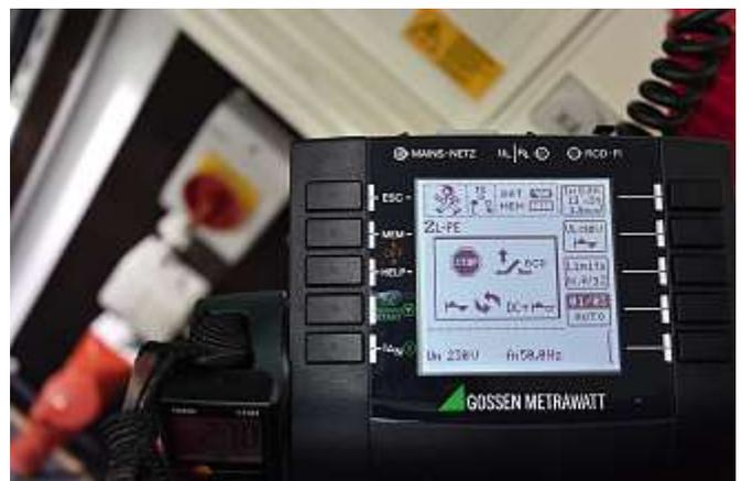
**Bild 63:** Meldung des Prüfgerätes bei der Messung  $Z_{L-PE}$  bei Auslösung des RCDs
