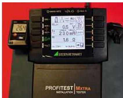
**Bild 55:** Wechselstromsensitive Messung (NK) mit einem zu erwartenden Messwert für  $I_{\Delta}$  von 230 mA
