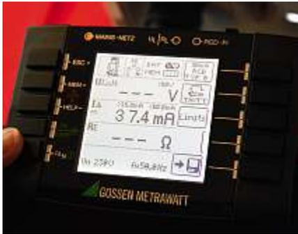
**Bild 52:** Gleichstromsensitive Messung (B+) mit einem zu erwartenden Messwert für  $I_{\Delta}$  von 37,4 mA
