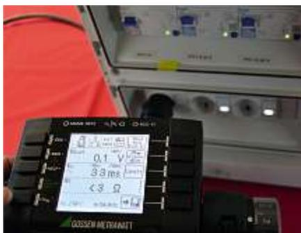
**Bild 49:** Wechselstromsensitive Messung (B+) mit Faktor 5 und einem zu erwartenden Messwert für  $t_a$  von 33 ms
