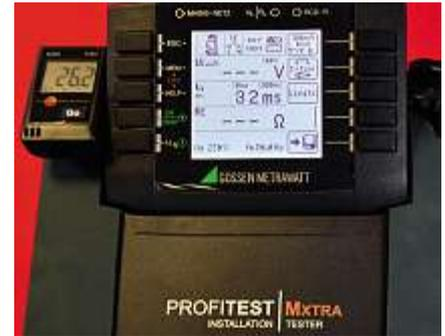
**Bild 56:** Gleichstromsensitive Messung (NK) mit Faktor 1 und einem zu erwartenden Messwert für  $t_a$  von 32 ms
