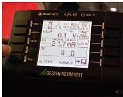
**Bild 50:** Wechselstromsensitive Messung (B+) mit einem zu erwartenden Messwert für  $I_a$  von 21,7 mA
