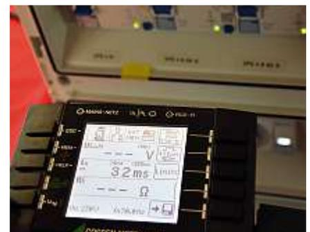
**Bild 51:** Gleichstromsensitive Messung (B+) mit Faktor 1 und einem zu erwartenden Messwert für  $t_a$  von 32 ms
