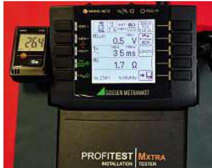
**Bild 54:** Wechselstromsensitive Messung (NK) mit Faktor 5 und einem zu erwartenden Messwert für  $t_a$  von 35 ms
