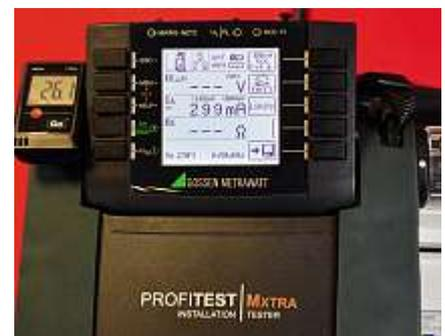
**Bild 57:** Gleichstromsensitive Messung (NK) mit einem zu erwartenden Messwert für  $I_{\Delta}$  von 299 mA
