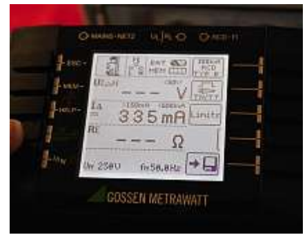
Bild 48: Gleichstromsensitive Messung mit einem zu erwartenden Messwert für I_A von 335 mA
