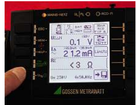
Bild 42: Wechselstromsensitive Messung mit einem zu erwartenden Messwert für I_A von 21,2 mA
