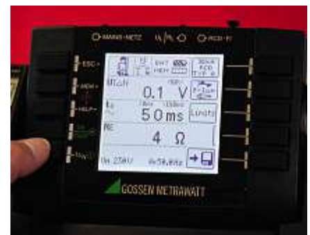
Bild 39: Wechselstromsensitive Messung mit dem Faktor 2 und einer Auslösezeit t_a von 50ms
