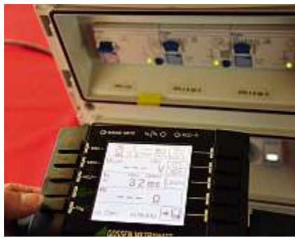
Bild 47: Gleichstromsensitive Messung mit dem Faktor 1 und einer Auslösezeit t_a von 32 ms
