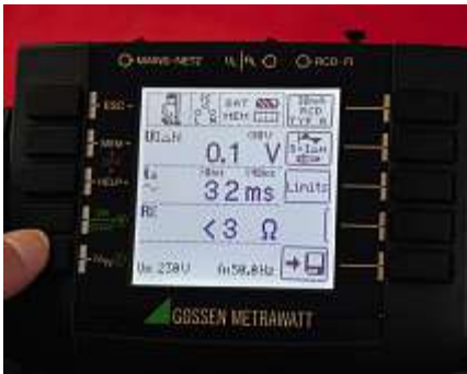
Bild 40: Wechselstromsensitive Messung mit dem Faktor 5 und einer Auslösezeit t_a von 32 ms
