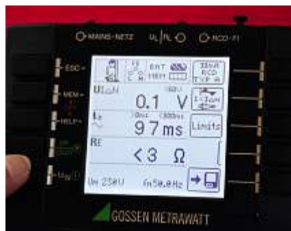
Bild 38: Wechselstromsensitive Messung mit dem Faktor 1 und einer Auslösezeit t_a von 97ms
