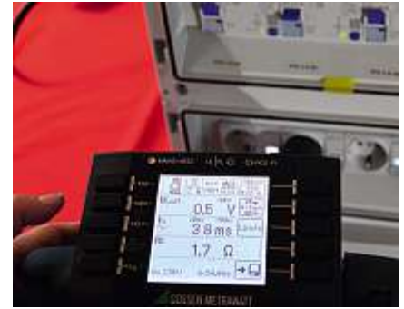
Bild 45: Wechselstromsensitive Messung mit dem Faktor 5 und einer Auslösezeit t_a von 38 ms
