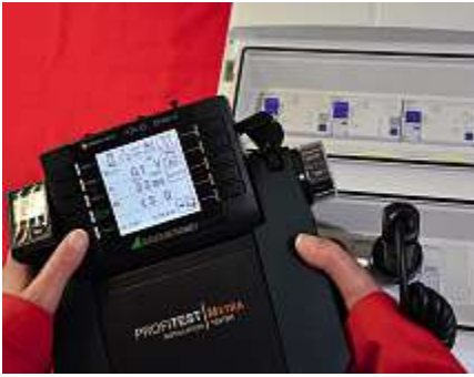
Bild 43: Wechselstromsensitive Messung mit dem Faktor 5 und einer Auslösezeit t_a von 33 ms
