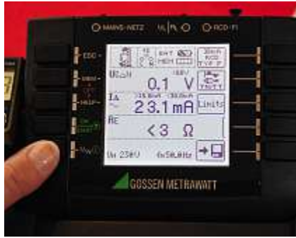
Bild 44: Wechselstromsensitive Messung einem zu erwartenden Messwert für I_A von 23,1 mA
