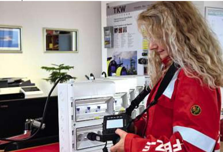
**Bild 36:** Aufbau des Prüfplatzes für die RCD-Prüfungen
