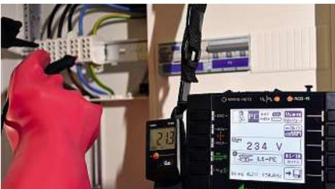
**Bild 27:** Zweipolige Messungen an der Hauptleiterabzweigklemme
