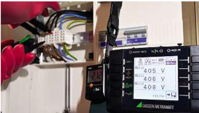
**Bild 26:** Dreipolige Messung an der Hauptleiterabzweigklemme
