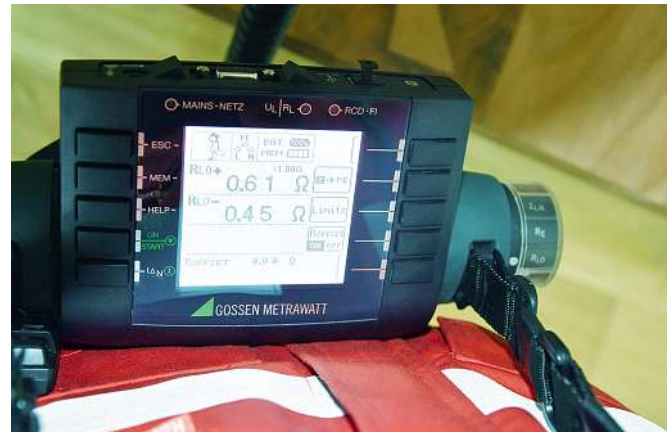
Bild 11: Messergebnis für die Durchgängigkeit des Schutzleiters mit zwei Werten
