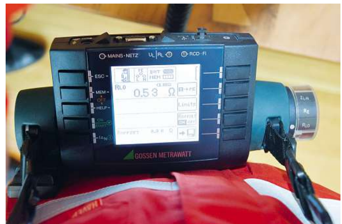
Bild 12: Messergebnis für die Durchgängigkeit des Schutzleiters mit einem Wert
