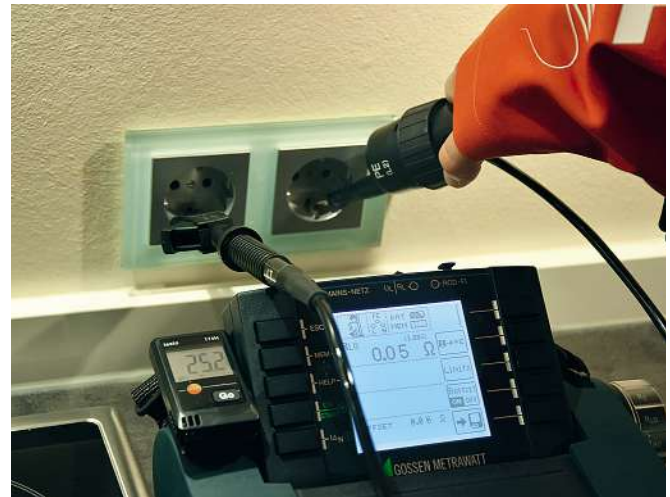
Bild 6: Messung des Schutzleiters einer Steckdose nach dem Prinzip des streckenweisen Messens mit einem zu erwartenden Wert von 0,05\ \Omega
