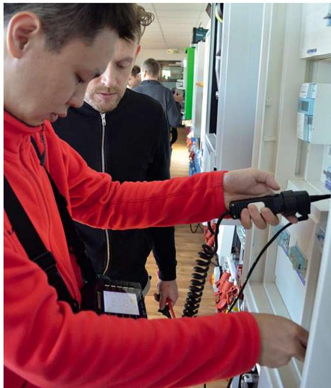
zurückliegende Nutzung der elektrischen Anlage durch entsprechendes Abfragen zur Sicherstellung eines noch ordnungsgemäßen Zustandes. Die Messungen und Prüfungen der Erstprüfung dienen auch bei der Wiederholungsprüfung zur Feststellung ausreichender Sicherheit.
