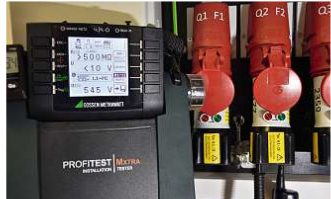
Bild 21: Isolationswiderstandsmessung über eine Drehstromsteckdose mit einem zu erwartenden Messwert von >500\text{M}\Omega
