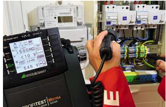
Bild 20: Isolationswiderstandsmessung abgangsseitig einer RCD-LS-Kombination mit einem zu erwartenden Messwert von >500\text{ M}\Omega
