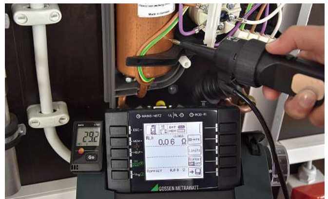
Bild 13: Messung an einem Durchlauferhitzer zur Durchgängigkeit des Schutzleiters mit einem zu erwartenden Wert von 0,06 Ω
