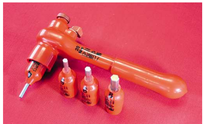
Bild 3: Fest eingestellte Drehmomentratsche von Lemp
