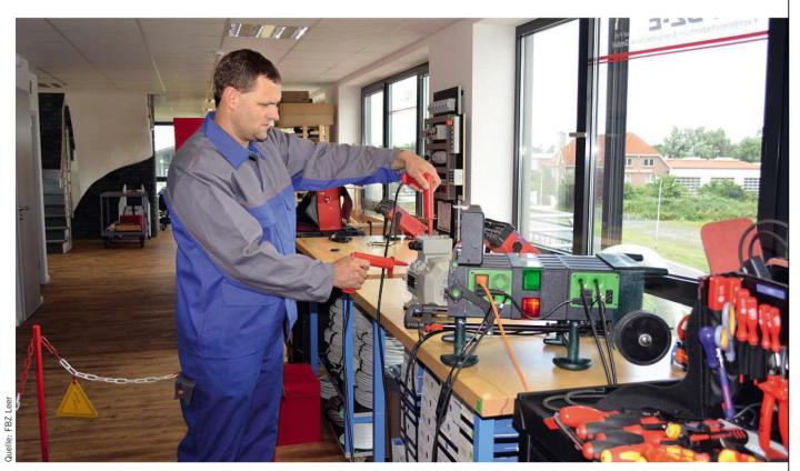
Hochspannungsprüfung an Motoren: Im Fachbereichszentrum Energietechnik FBZ-E in Leer führt ein Teilnehmer diese Prüfung in einem abgegrenzten Prüfbereich durch – auf den Seiten 78 und 79 in dieser Ausgabe erfahren Sie übrigens noch mehr über Profis für elektrische Maschinen
